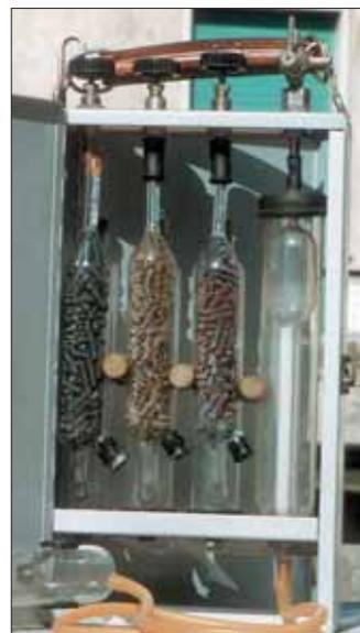
Anni 1950. Primo catalizzatore portatile per controllo combustione.
