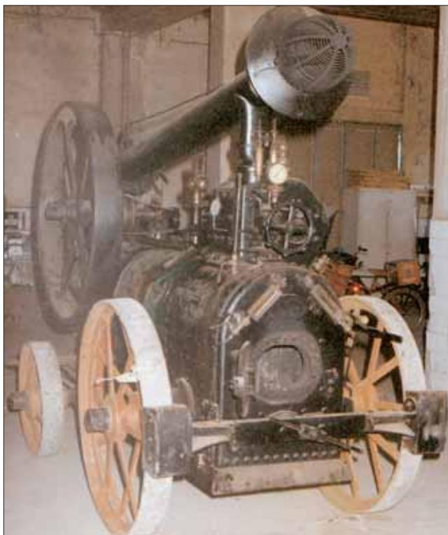
Locomobile 1911 - Nata per la trebbiatura del grano. Combustibile biomasse e scarti di lavorazione (sansa, vinacce, ecc.).
